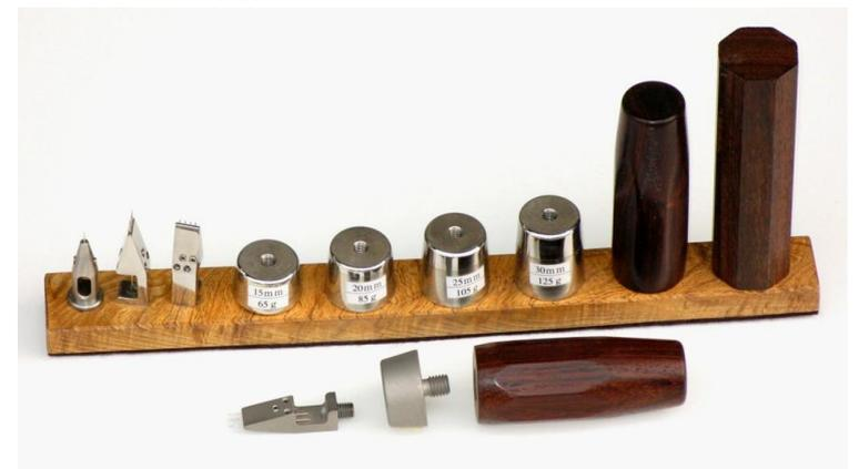
写真 13 キャップウェイト+交換式グリップの組み合わせ
