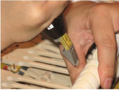
写真5 5針ヘッドによる突き針作業
