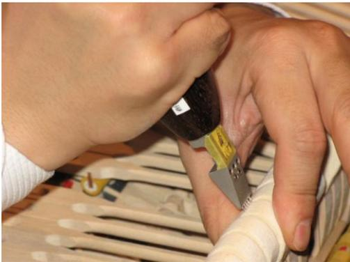
写真6 5針ヘッドによる突き針作業
